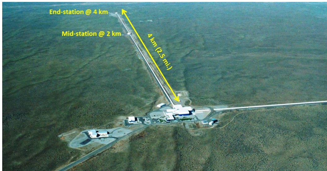
شکل ۱ - بازوی تداخل‌سنجی رصدخانه‌ی LIGO (این شکل کمکی به حل سؤال نمی‌کند)
